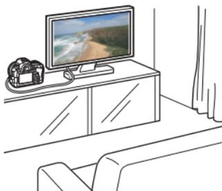
Dengan menghubungkan kamera ke perangkat TV dengan kabel HDMI, Anda dapat memainkan ulang foto dan film kamera di perangkat TV.
