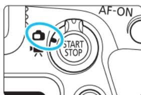
Anda dapat memotret selagi melihat gambar pada monitor LCD kamera. Ini disebut sebagai “Pemotretan Live View”. Pemotretan Live View diaktifkan dengan mengatur sakelar Pemotretan Live View/ Perekaman film ke
