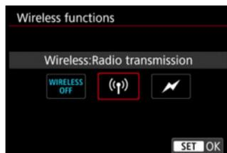
Fotografi (beberapa) blitz nirkabel dimungkinkan dengan transmisi radio atau optik.
